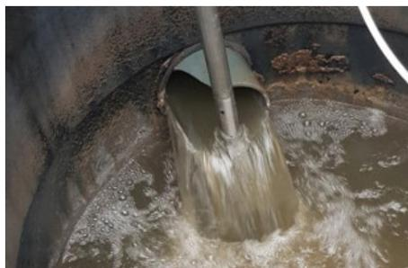
Der SulfiLogger™ Sensor wurde direkt im rohen Abwasser des Zuflusses im Schacht platziert.
