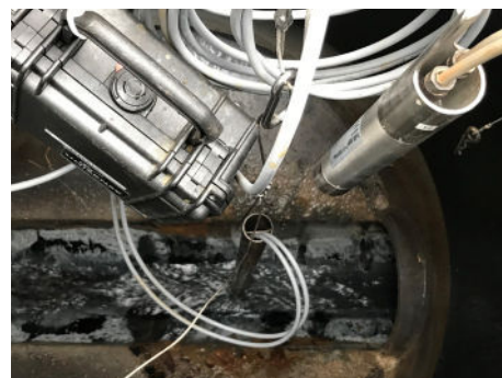
To af SulfiLogger™-sensorerne, der måler i væsken og lige under brønddækslet.
